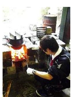
・鉄板を使用する場合は、耐火煉瓦を1段下げて、鉄板に火が届くようにします。
